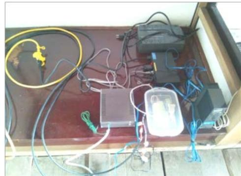
＜図 2：(左) 磁力計 (OBEM) から母屋への配線図。(右) 母屋に置いたデータ収録機器。白いタッパーウェアに入っているのがデータロガー。その右は ISDN ルーター、残りの機器は UPS その他の電源装置である。これらの電源機器はインターネット越しに接続が可能になっている。＞
