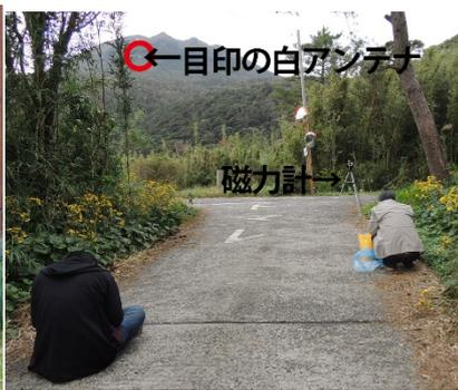
数 m 毎に移動しながら、水準器と単眼鏡 (Nikon 6x5 7.5p) を取り付けたフラックスゲート磁力計 (国際電子 KEI-9220、センサー部は Bartington 製 MAG-03) を非磁性仕様の三脚に載せて目印に方角を合わせ測定しました。目印は御岳中腹の白アンテナと、観測小屋からは尖って見えるネガミ岳の小ピークとしました。測定値は、絶対磁気儀やプロトン(オーバーハウザー)磁力計とは異なり、ベース値
