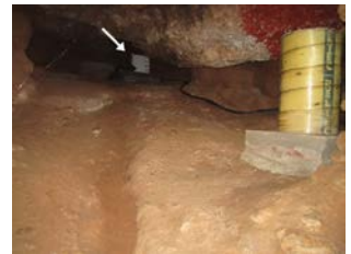
＜フラックスゲート磁力計のセンサー(矢印で示されているもの)。右側は地震計のセンサー。＞
