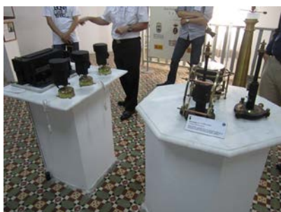
< 観測に使われていた光学記録式吊り下げ型磁力計。 >
