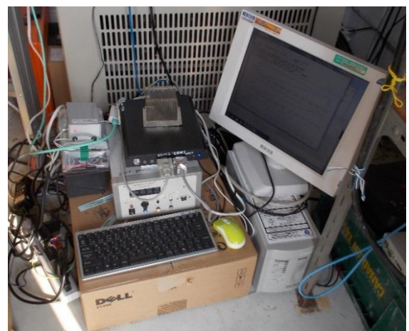
< 観測室内のデータロガーと PC。モニターは磁力計から得たデータをリアルタイム表示している。 >
