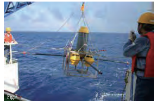
Fig.7 船上から投入される海底電磁気観測ステーション (SeaFloor ElectroMagnetic Station, SFEMS)。この装置は、オーバーハウザー型絶対全磁力計とフラックスゲート型三分磁力計を搭載し、海底で複数年の無人連続観測が可能。
